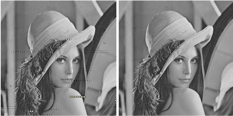
Abbildung 3.8: Resultate für die separierbare 2D-DST, ohne (links, pSNR_{dB} = 28,05 dB) und mit (rechts, pSNR_{dB} = 48,14 dB) der optimalen Schätzlösung ( H = 5,02 bpp).
