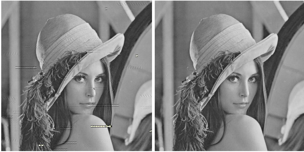
Abbildung 3.7: Resultate für die eindimensionale DST, ohne (links, pSNR_{dB} = 28,37 dB) und mit (rechts, SpNR_{dB} = 49,95 dB) der optimalen Schätzlösung ( H = 5,83 bpp).
