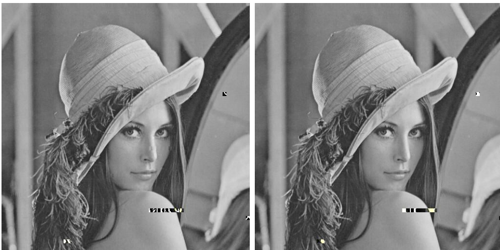
Abbildung 3.12: Resultate für die CCT ( \varepsilon = 0.0 ), ohne (links, pSNR_{dB} = 29,18 dB) und mit (rechts, pSNR_{dB} = 29,56 dB) der optimalen Schätzlösung ( H = 4,38 bpp).
